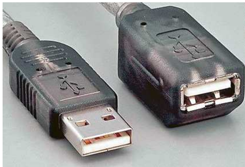
Rysunek 3. Kabel magistrali USB.
