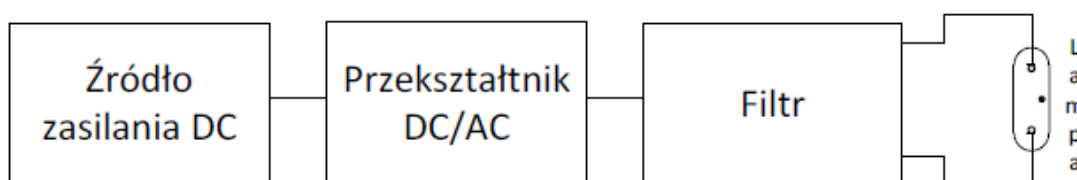
Rys. 1. Schemat blokowy obwodu mocy typowego statecznika lampy fluorescencyjnej
